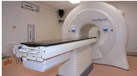
Figure 1 / La tomothérapie : un accélérateur combinant un accélérateur à un scanner
